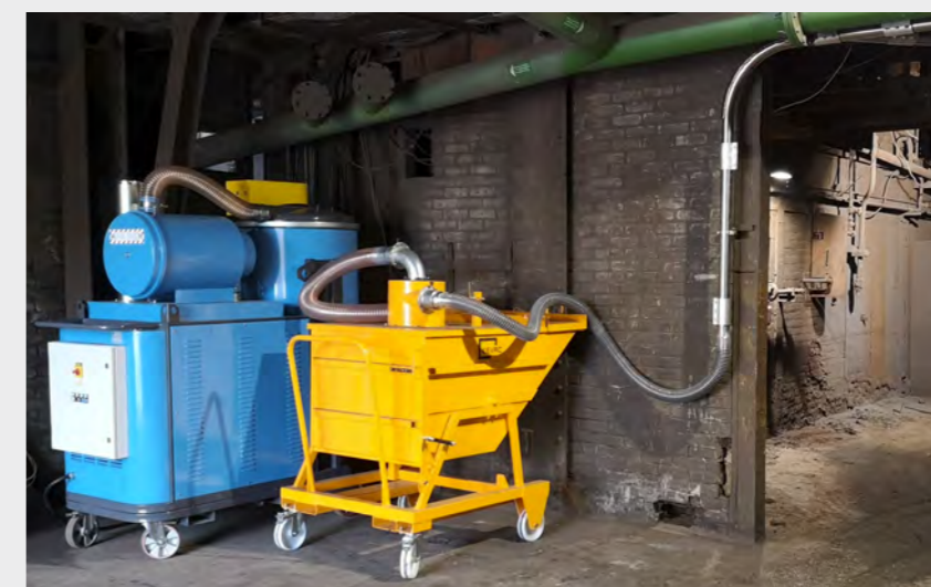
Réseau centralisé pour l'aspiration sur plancher de coulée
