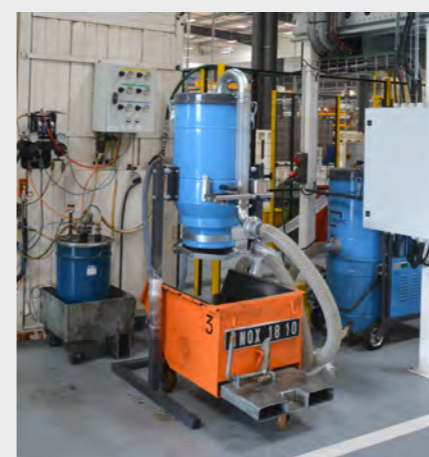
Aspiration avec trémie à ouverture totale collecte déportée dans contenant client
