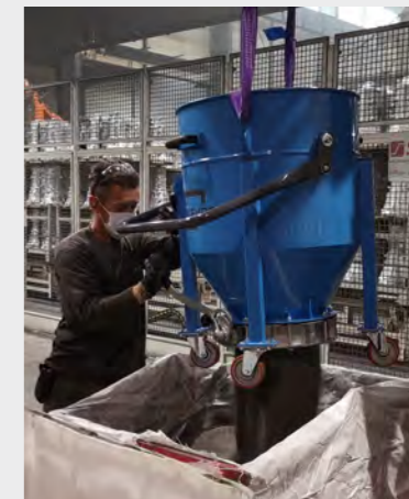
Vidange de grenailles aisée avec cuve équipée d'un fond ouvrant
