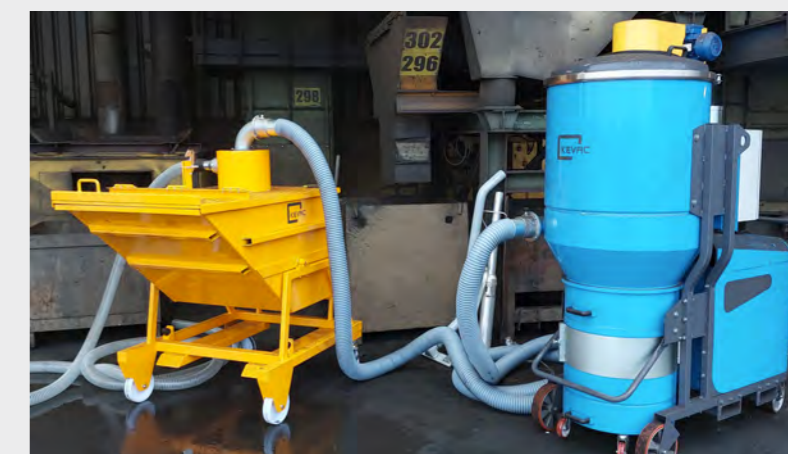
Réseau centralisé pour l'aspiration sur plancher de coulée
