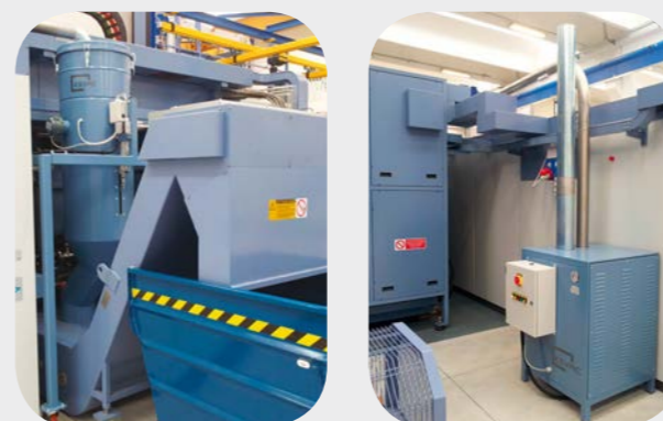
Réseau centralisé pour l'aspiration de copeaux sur plusieurs postes opérateurs avec déchargement automatique sur convoyeur d'évacuation à tapis métallique
