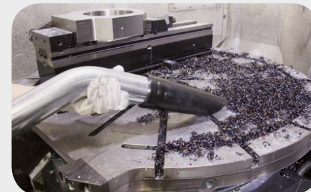
Aspiration de copeaux d'un centre d'usinage multibroche
