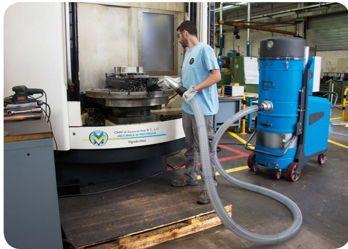
Aspiration de copeaux sur centre d'usinage universel à 5 axes
