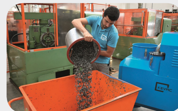
Vidage du panier à copeaux suite au nettoyage d'un centre d'usinage de taillage d'engrenages coniques
